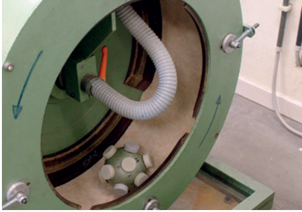
Şekil 14. Vettermann test tamburu ve aşındırma amacıyla kullanılan çelik top
