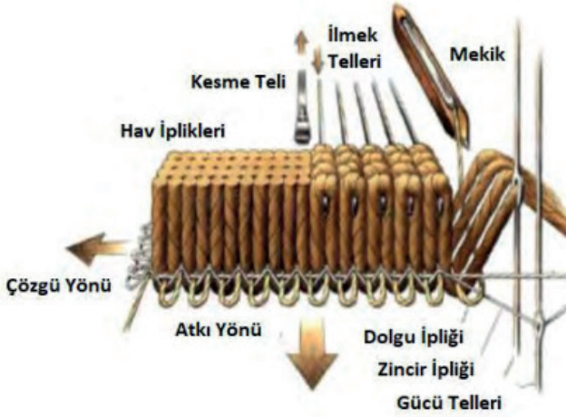
Şekil 7. Telli Wilton tipi halı yapısı (Sarioğlu vd., 2019)
