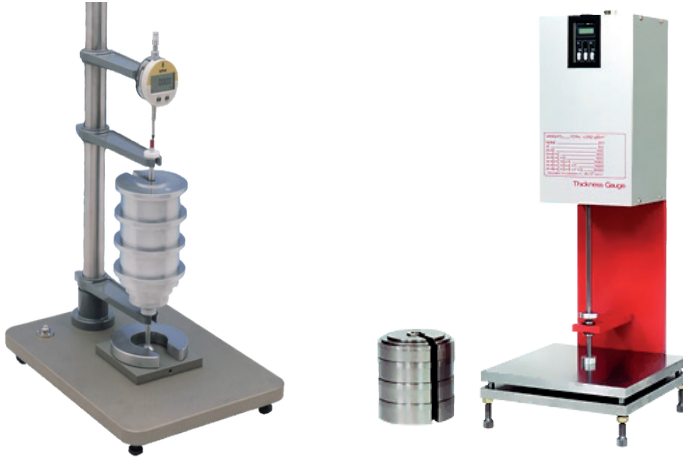
Şekil 8. Kalınlık ölçüm cihazı ve sıkıştırma geri dönme testi ağırlık seti
