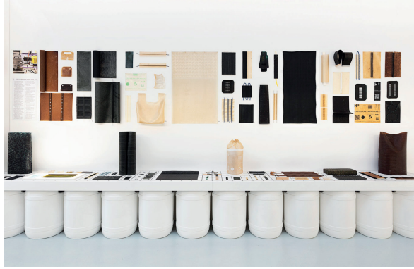
Görsel 12. İstilacı deniz yosunu türlerinden elde edilen biyokütlenin işlenmesiyle geliştirilen esnek biyomalzeme örneklerine genel bakış (Tomatis, t.y.).
