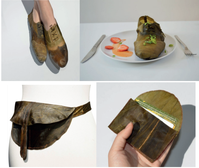
Görsel 16. Jing-cai Liu'nun “Kelp” adlı projesi kapsamında, deniz yosunu bazı biyomalzeme kullanılarak geliştirilen aksesuar ve prototip tasarımlar (Liu, t.y.).
