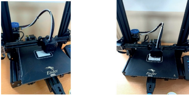
Şekil 4: Tasarlanan aparatın 3D yazıcıda basım aşaması
