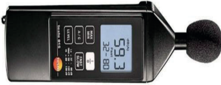
Şekil 1. Testo-815 gürültü ölçüm cihazı
