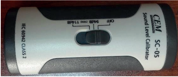
Şekil 2. CEM SC-05 ses seviyesi kalibratörü
