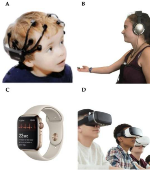
Şekil 1. Eğitim Ortamlarında Biyometrik Verilerin Elde Edildiği Bütünleşik Sensör Teknolojileri Ve Giyilebilir Cihazlar (Hong vd., 2025): A. EEG sistemli başa takılabilen sensörler (Alvarez vd., 2016); B. Göğse takılabilen biyomedikal sensörler (Cowperthwait vd., 2015); C. Bileğe takılabilen çoklu sensörler (Laverde vd., 2018); D. Başa takılabilen sanal gerçeklik özelliklerine sahip sensörler (Khosravi vd., 2022).
