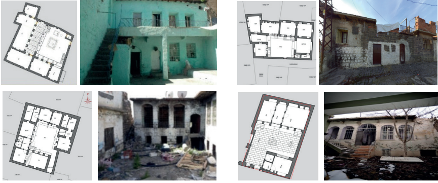
Şekil 7. Diyarbakır geleneksel evlerine ait plan tipolojileri
