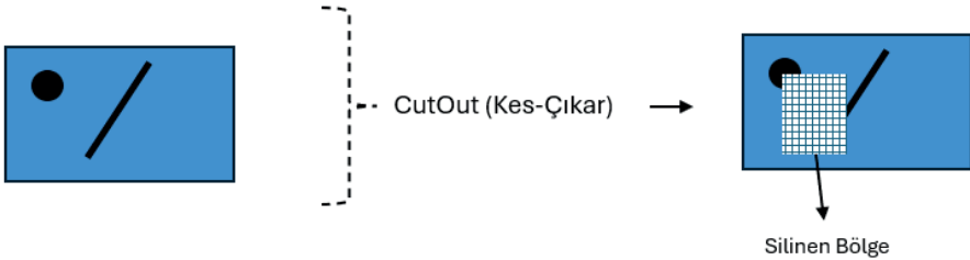
Şekil 3: Cutout yönteminin akış şeması
