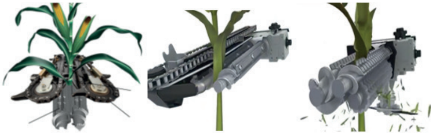
Şekil 9. Mısır başlığının yaptığı işlemler.
