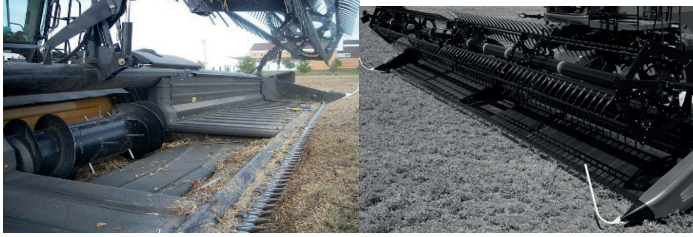
Şekil 6. Bezelye, fasulye, tahıllar ve buğday için kullanılabilen draper başlık tipi.
