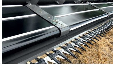
Şekil 5. Konveyör bantları yerine paslanmaz çelik kullanılan draper başlık.
