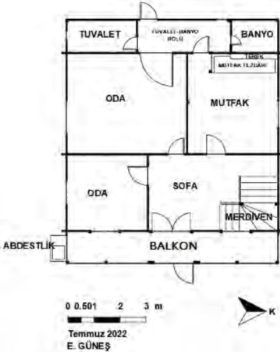
Görsel 5.45. Alan Köyü Muhittin Şensoy Evi zemin kat sofası köşede bulunan (çıkmasız) iç sofası tipi
