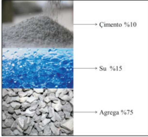
Şekil 1: Hazır Beton Bileşenleri
