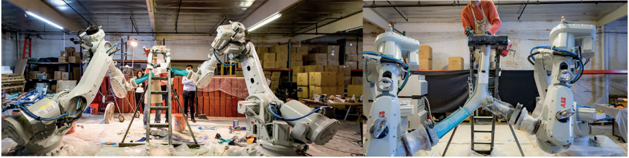
Şekil 7. Robotik kollarla kontrol edilen kumaş içerisinde beton dökümü (URL-7)
