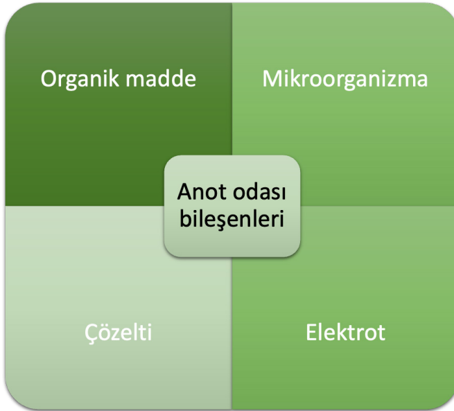
Şekil 3.3. Mikrobiyal yakıt hücresi anot odasının temel bileşenleri [76-78].
