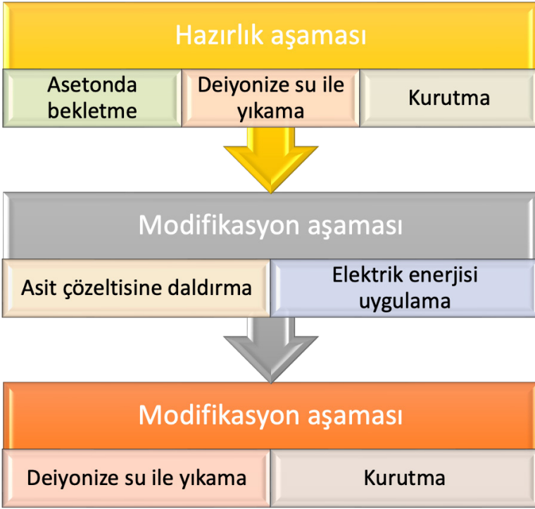
Şekil 3.9. Anot elektrotunun modifikasyonu için yapılan örnek bir işlemin iş akış şeması [87].
