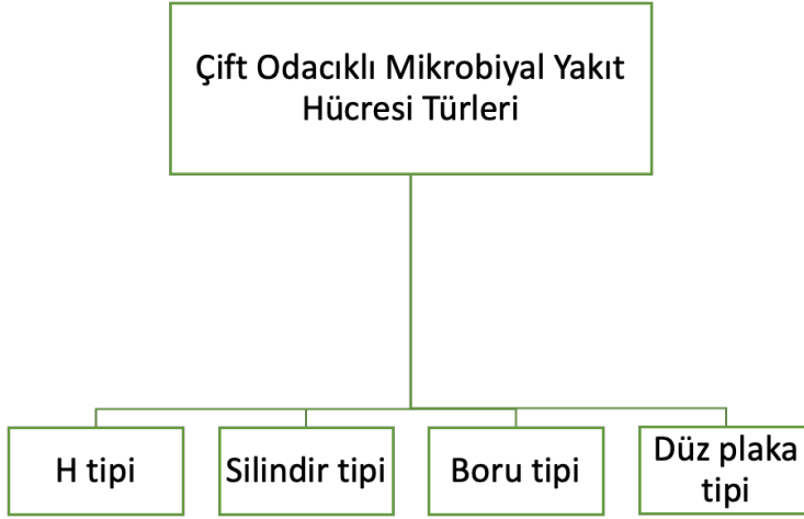
Şekil 2.7. Çift odacıklı mikrobiyal yakıt hücresi türleri [56].
