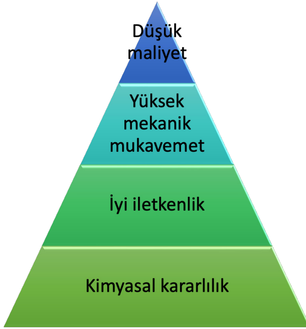
Şekil 3.5. Mikrobiyal yakıt hücrelerindeki elektrotların sahip olması gereken temel özellikler [75,85].
