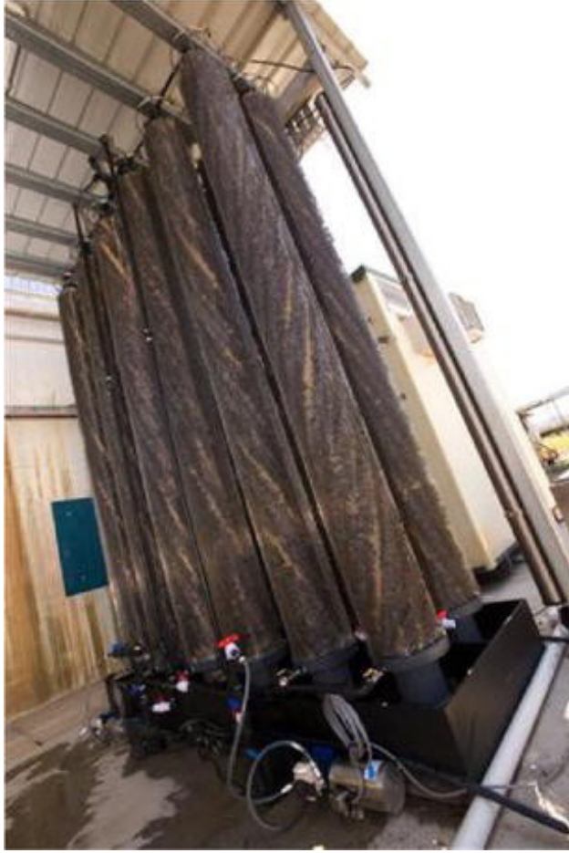
Şekil 1.12. Avustralya, Yatala'daki Foster's bira fabrikasında üretilen atık su kullanılarak güç üretimi için test edilen boru şeklindeki mikrobiyal yakıt hücreleri [40].
