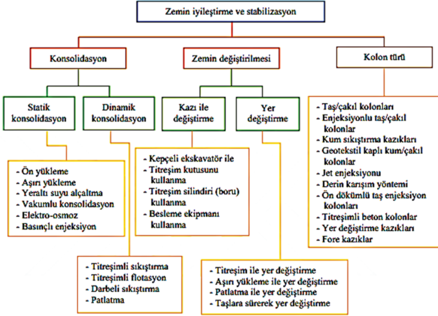
Şekil 2. Das (1983) den geliştirilen zemin iyileştirme yöntemleri (Kempfert ve Gebreselassie, 2006).
