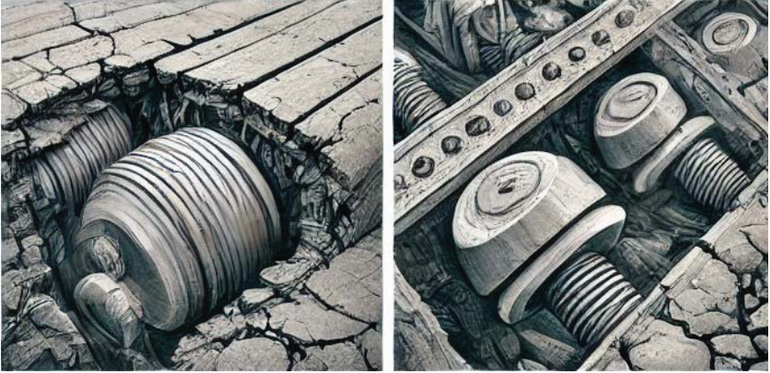
Şekil 8. Deprem etkisi altında köprü ve viyadüklerde rastlanan mesnet yatağı hasar örneği “Yazar tarafından hazırlanmıştır.”
