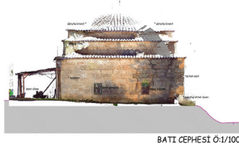
Şekil 3. Batı Cephesi Lazer Tarama Verisi (Renkli Nokta Bulutu Görseli)
